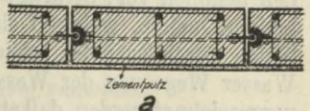
Eisenbetonspundbohlen d. Firma Drenckhahn & Sudkop mit eiserner Nut u. Feder.
