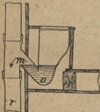
Abb. 56. Abort mit Kotverschluß.
