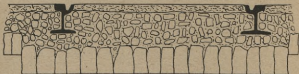
Abb. 48. Gleis in Steinschlagstraße.
