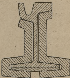
Abb. 42. Fußlaschenverbindung mit Keilfußplatte.
