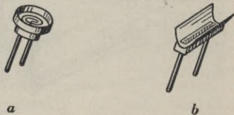
Abb. 6. Glühkathoden mit Fokussierungseinrichtung, a) für kreisförmigen Brennfleck, b) für strichförmigen Brennfleck.
