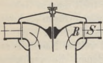
Fig. 5. Das Schema der Francisturbine. S ist das Leitrad, R das Laufrad.
