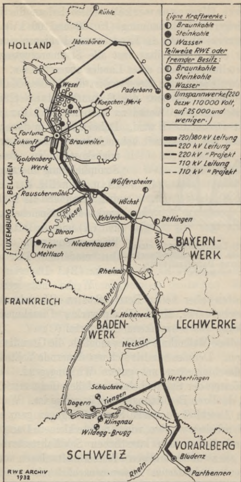
Fig. 3. Hochspannungsnetz der RWE-Betriebe.
