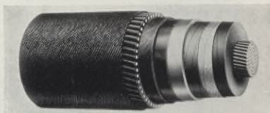
Abb. 3. H-Kabel für 100 kV mit schwach magnetischer Stahldrahtbewehrung (Außendurchmesser 96 mm).
