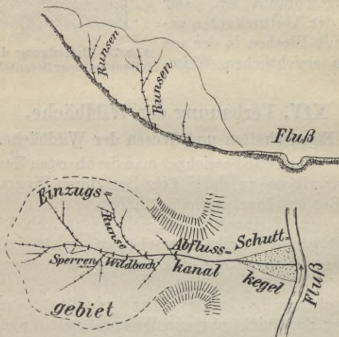
Abb. 76. Schematische Darstellung der Hauptteile eines Wildbaches.
