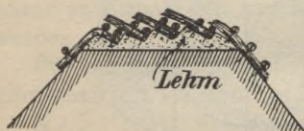
Abb. 46. Befestigung der Krone einer Packwerksbühne mit einer Rauiwehr.
