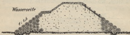
Abb. 33. Parallelwerk aus Senkfaschinen mit Kieskern.
