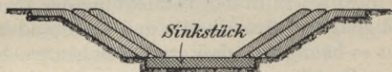
Abb. 60. Herstellung eines Zuschlußbaues aus Packwerk von beiden Seiten mit Grundlage aus Sinkstücken.
