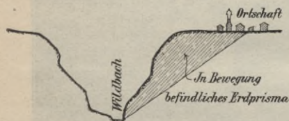
Abb. 78. Folgen der Hangunterwühlung durch einen Wildbach.
