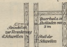
Befestigung der Holzschwellen.
