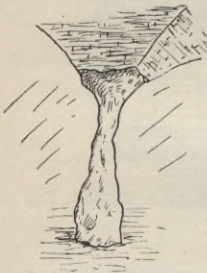
Abb. 5. Querschnittsverminderung einer Granitsäule nach einem Brande.
