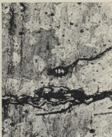
Abb. 39. Nickelstahl. Risse durch
