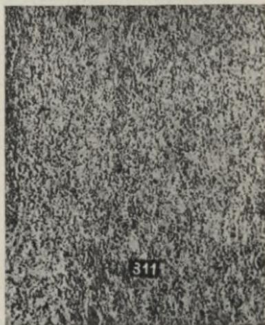
Abb. 31. Stahl weichgeglüht. Gefüge körniger Perlit. Vergr. = 265 fach.
