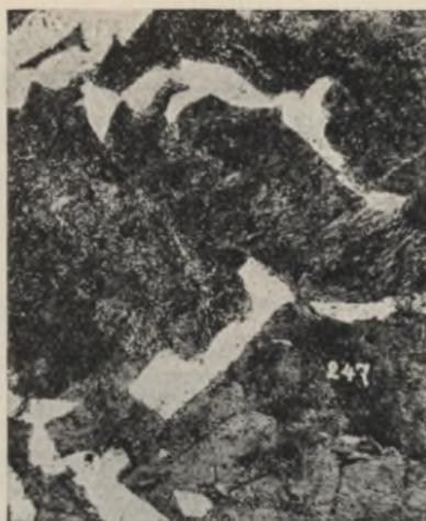
Abb. 26. Grobkörniger geschmiedeter Stahl, bestehend aus Ferrit (hell) und streifigem Perlit (dunkel).
