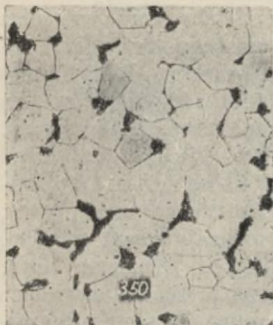
Abb. 22. Kohlenstoffarmer, weicher Stahl. Ferrit (hell) u. Perlit (dunkel). Vergr. = 265 fach.
