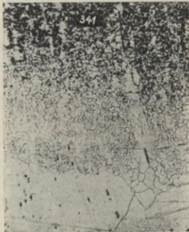
Abb. 37. Kornvergrößerung und Entkohlung durch örtliche Überhitzung an einer Stahlgleichrichterelektrode. Vergr. = 74 fach.
