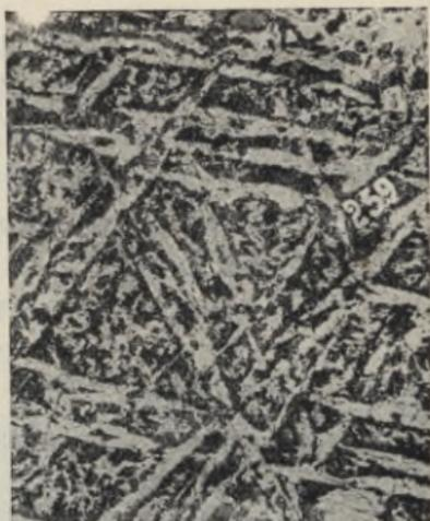
Abb. 27. Unausgeglühter spröder Stahlguß. Widmannstättensche Figuren. Vergr. = 265 fach.
