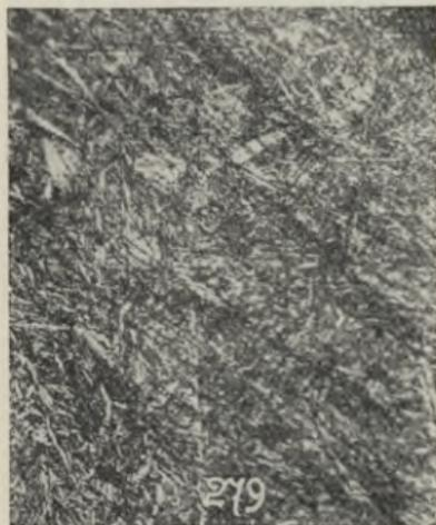
Abb. 24. Derselbe Stahl wie Abb. 23, aber im Einsatz gehärtet. Martensit aus der Einsatzschicht.
