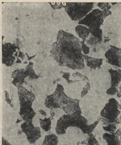
Abb. 49. Grobkörniger Stahlguß bestehend aus Ferrit (hell) u. Perlit (dunkel). Vergr. = 265 fach.
