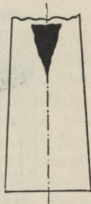
Abb. 18. Schematische Darstellung eines Lunkers.
