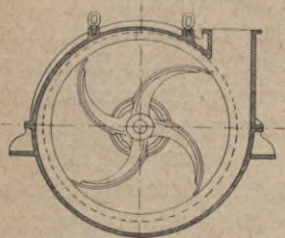
Abb. 81. Längsschnitt durch eine Kreiselpumpe für Saugbagger.
