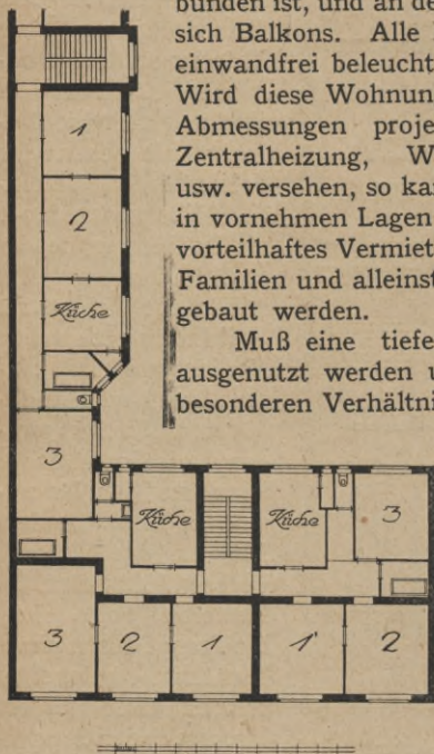
Abb. 8. Haus mit Anbau, mit 3-Zimmerwohnungen mit Bad.
