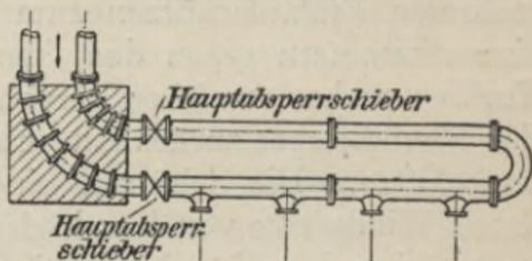
Fig. 81. Verteilungsrohrleitung als Ringleitung ausgebildet.
