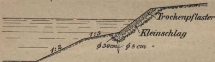
Abb. 18. Uferschutz aus Pflaster in Zementmörtel mit Wippenfuß.
