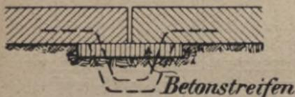
Abb. 22. Dichtung der Fugen zwischen den Belagplatten der Uferböschung beim Teltow-Kanal.
