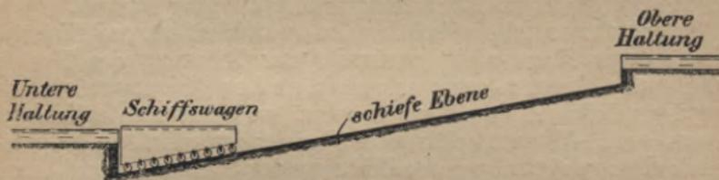
Abb. 66. Längsbahn im Höhengchnitt.
