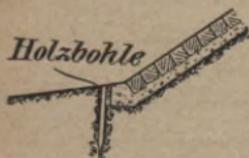
Abb. 19. Uferschutz aus Pflaster mit Bohlenfuß.
