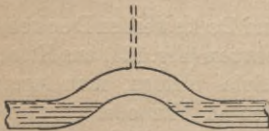
Fig. 128. Luftsack in einer Rohrleitung.
