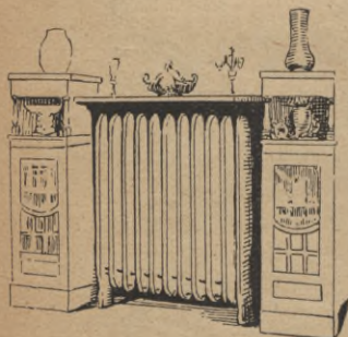
Fig. 162. Radiator mit moderner Umkleidung.
