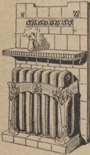
Fig. 164. Majolika-plattenhinterkleidung eines Heizkörpers.
