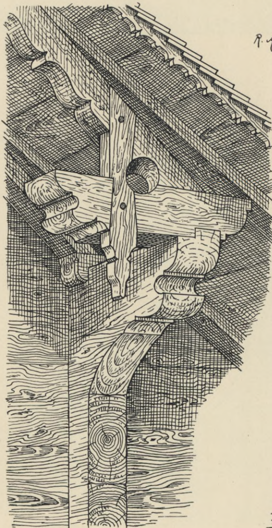
FENSTERDETAIL MIT·AUSGESCHNIT- TENEM·FLACHENBRETT
