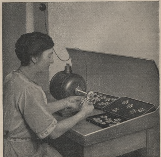
Abb. 2. Der silberne Rand der Eisernen Kreuze wird mit einem elektrischen Poliermotor blankgeputzt.
