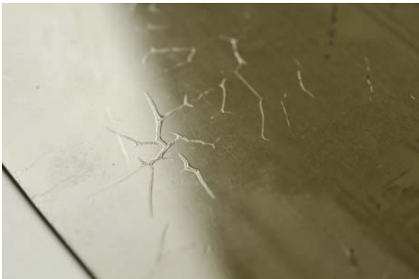
Ryc. 8. Detal negatywu kolodionowego, widoczne uszkodzenia warstwy obrazu oraz werniksu
