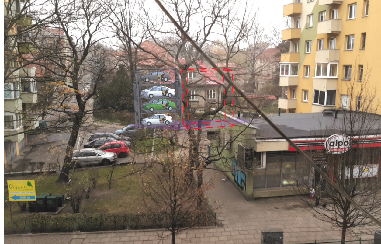
II. 5. model widziany z odległości około 60m (ścieżka dojścia 100m) z wyraźnie obecnym dryfem szacowanym na 6m (obrys czerwony wskazuje pierwotną pozycję modelu) – testy autorów III. 5. model seen from a distance of around 60 m (100 m approach path) with a clearly observable drift estimated at 6 m (the red outline shows the original position of the model)—tests performed by the authors
