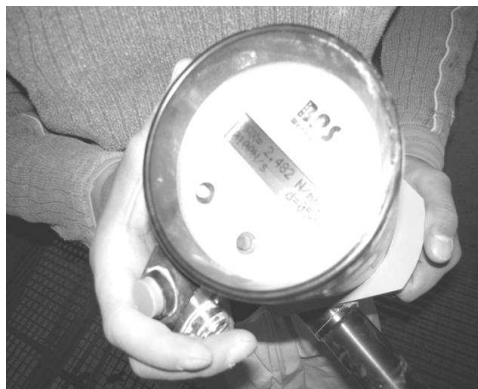
Fot. 3a), b), c), d) Sprawdzenie wytrzymałości betonu na odrywanie metodą PULL-OFF
