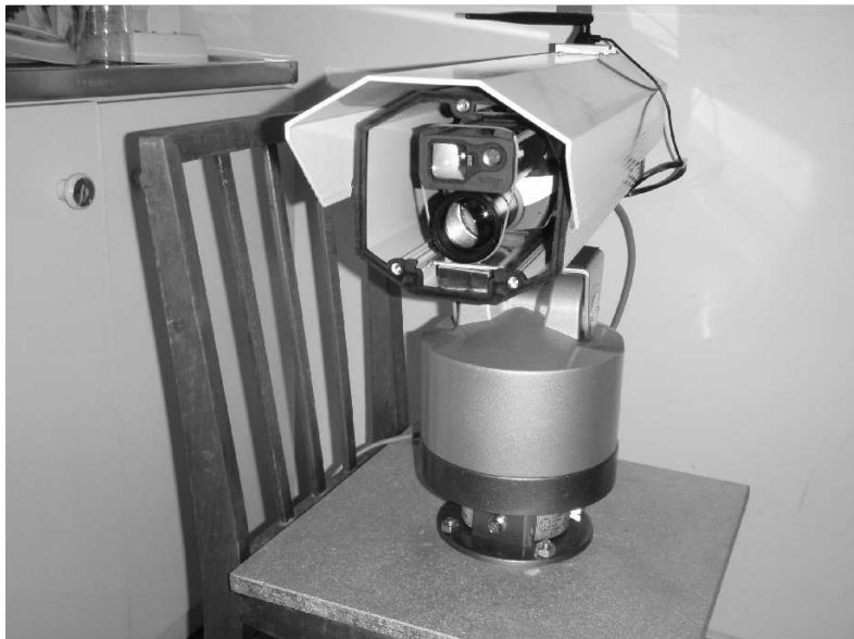
Fot. 2. Urządzenie do zdalnego pomiaru przemieszczeń
