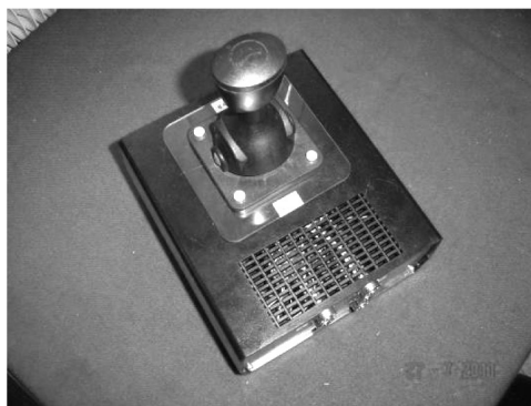
Rys. 15. Czterodrogowy rozdzielacz proporcjonalny i jego elektroniczny moduł sterujący [8]
