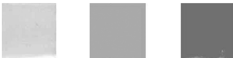
Rys. 4. Warstwy platynowe utworzone bezpośrednio na podłożu: od lewej: szkło przewodzące bez warstwy platynowej warstwa platynowa wytwarzana w 100°C przez 40 min warstwa platynowa wytwarzana w 120°C przez 40 min
