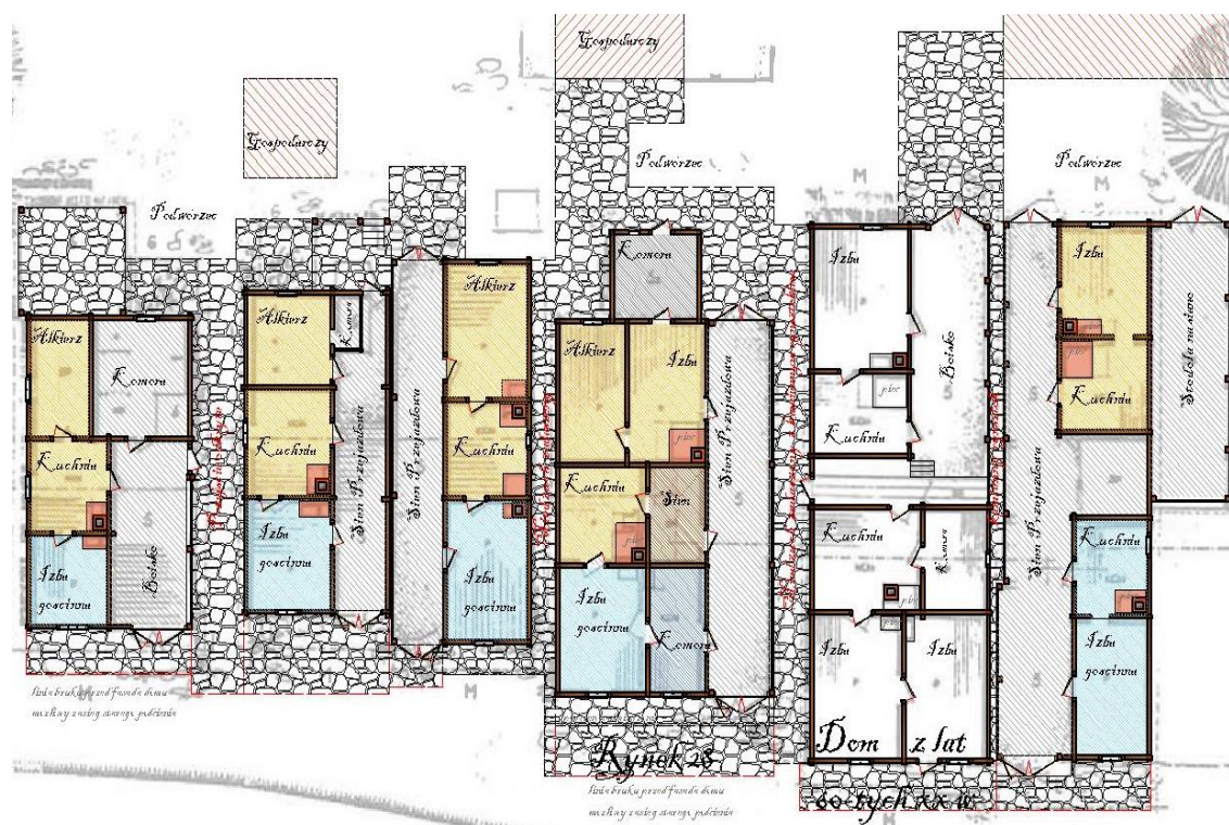
Rysunek 76. Rekonstrukcja układu zespołu pierzejowego u wylotu ulicy Węgierskiej z Rynku wykonana na podstawie materiałów opracowanych przez dr Augusta Bocheńskiego w latach 70-tych XX wieku. Na rysunku przedstawiono domy przejazdowe z nr 28 w centrum, obok którego jest zlokalizowany budynek wykonany w latach 60-tych XX w. pozbawiony kolorowego wypełnienia pomieszczeń. Rys. autor 2018 r. [AutoCAD 2014 LT]
