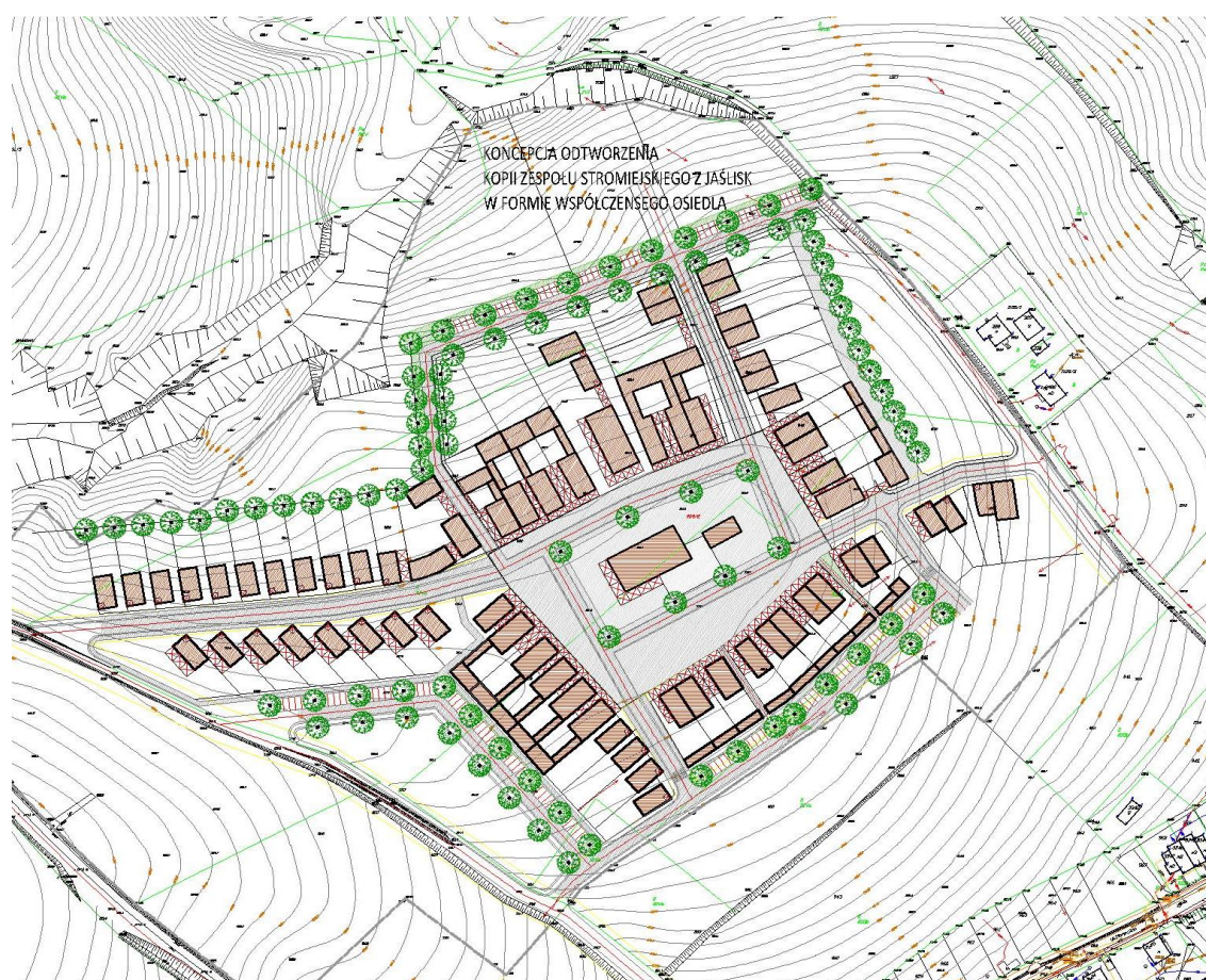
Rysunek 115. Koncepcja wstępna realizacji nowoczesnego osiedla mieszkaniowego o mieszanej funkcji mieszkalnej i turystycznej na przedmieściach miasta Biecz. Projekt odwzorowuje w perspektywie kształtu i wymiarów oryginalny układ turbinowy rynku w Jaśliskach z zachowaniem standardowych dla Jaślisk szerokości działek kurialnych, przy zbliżonej do oryginału liczbie zabudowań pierzejowych. Rys. autor 2018 r. [AutoCAD 2014 LT]
