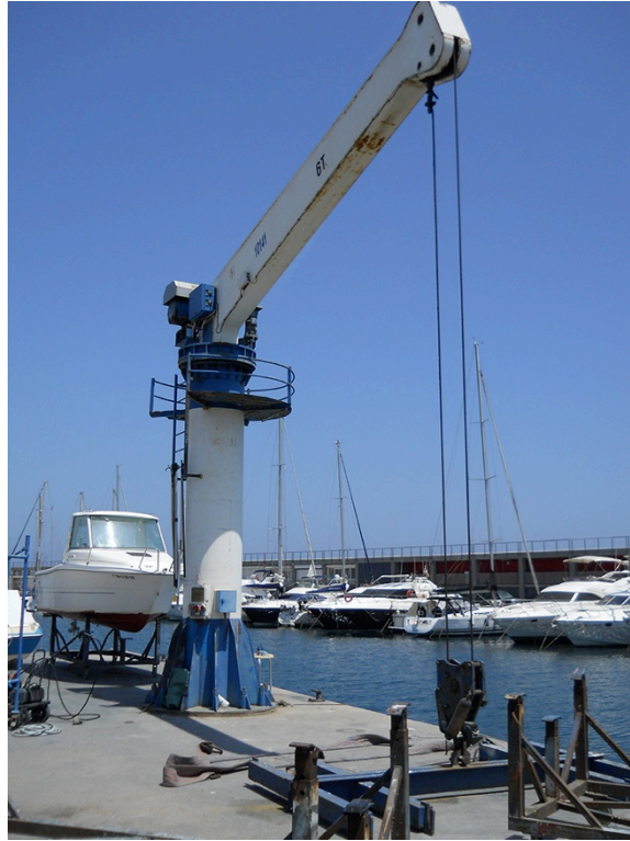
Rys. 4.39. Dźwignica stacjonarna. Źródło: autor
