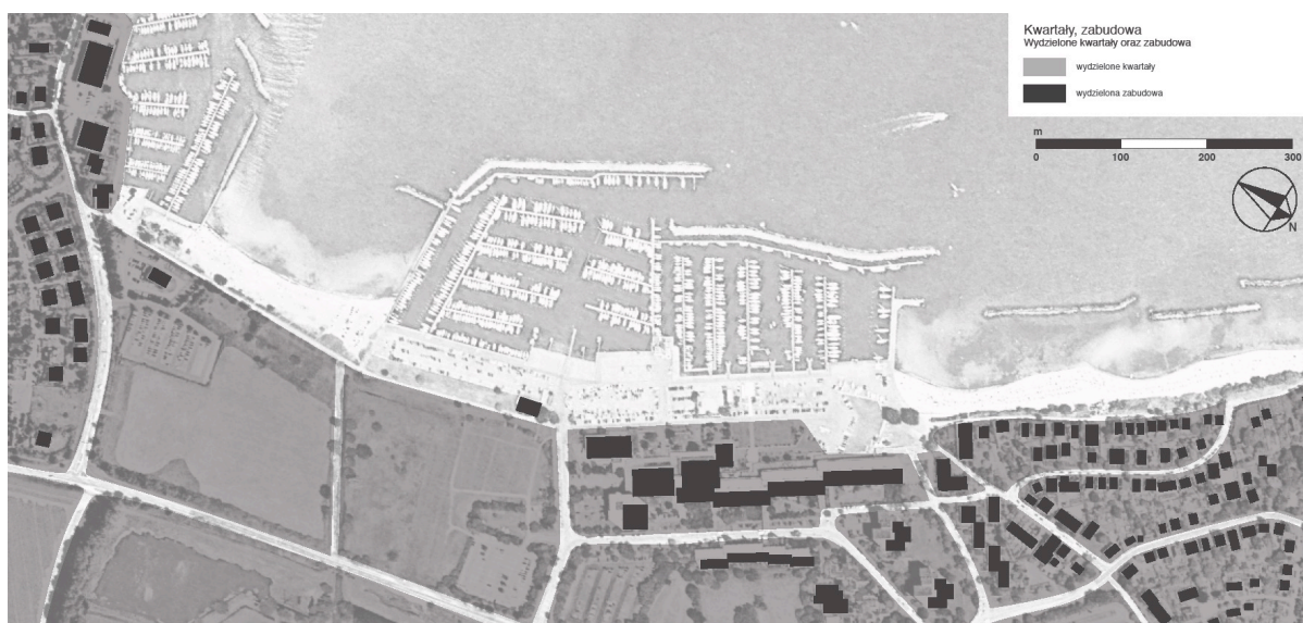
Rys. 3.11. Wyróżnienie kwartałów i zabudowy Schilksee Mariny na podstawie zdjęć satelitalnych, wizji lokalnej, inwentaryzacji fotograficznej; kolor szary – wydzielone kwartaly, czarny – wydzielona zabudowa. Źródło: autor
