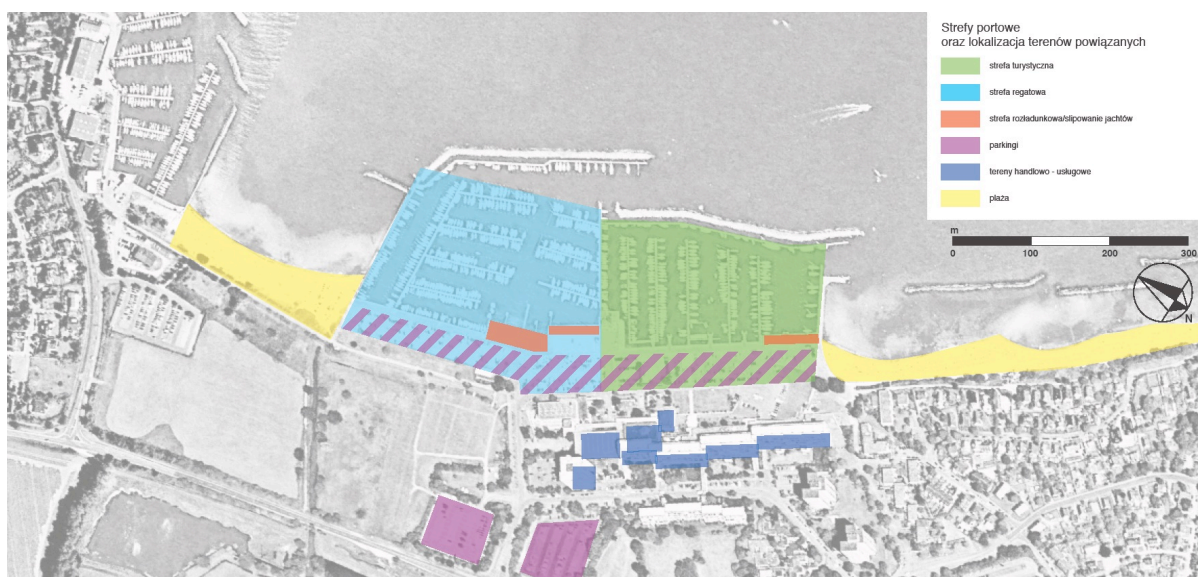
Rys. 3.15. Strefy portowe oraz lokalizacja terenów powiązanych Schilksee Mariny na podstawie zdjęć satelitarnych, wizji lokalnej, inwentaryzacji fotograficznej; kolor zielony – strefa turystyczna, błękitny – strefa regatowa, pomarańczowy – strefa rozładunkowa/slipowanie jachtów, fioletowy – parkingi, granatowy – tereny handlowo-usługowe, żółty – plaża. Źródło: autor
