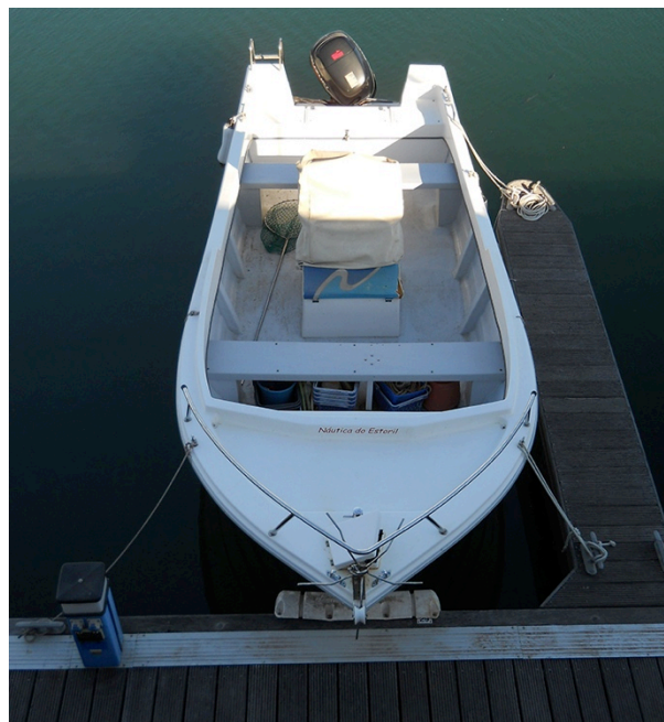
Rys. 4.35. Przykład prawidłowo zacumowanej jednostki przy pojedynczym pirsie pływającym. Źródło: autor
