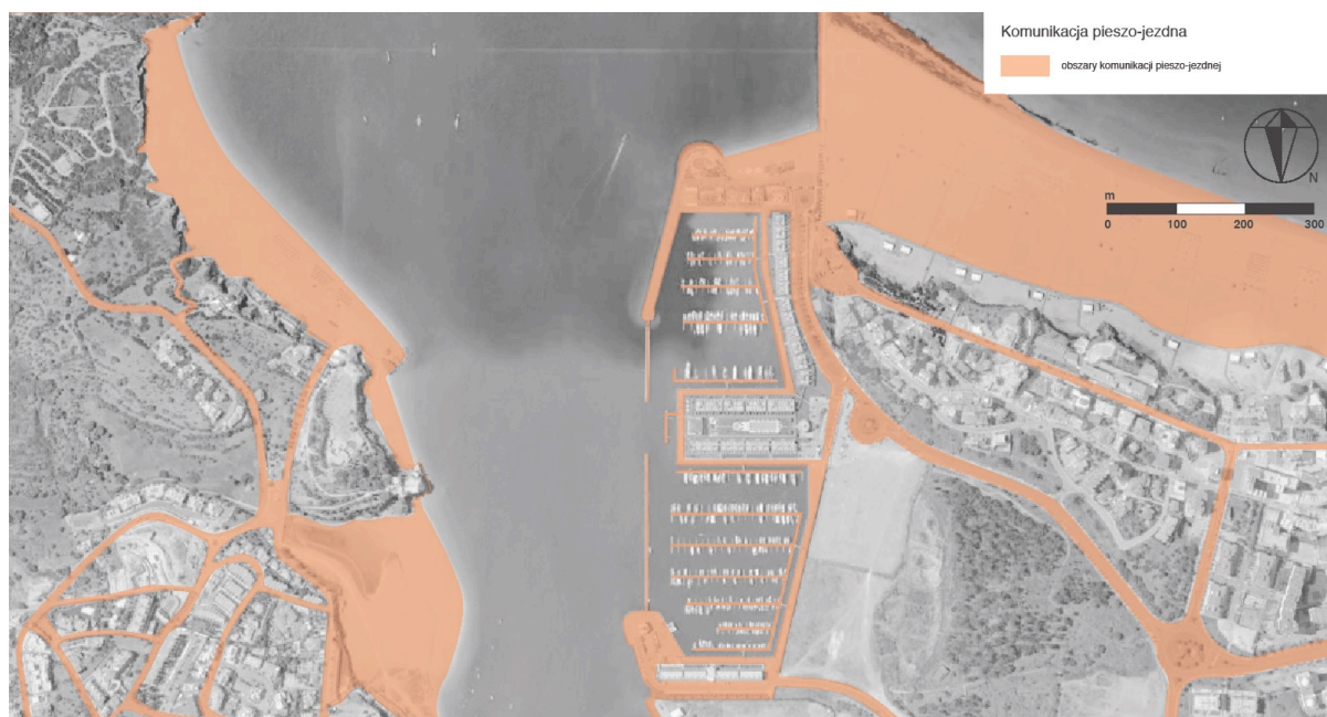
Rys. 3.75. Komunikacja pieszo-jezdna Mariny de Portimão na podstawie zdjęć satelitarnych, wizji lokalnej, inwentaryzacji fotograficznej; kolor łososiowy – obszary komunikacji pieszo-jezdnej. Źródło: autor
