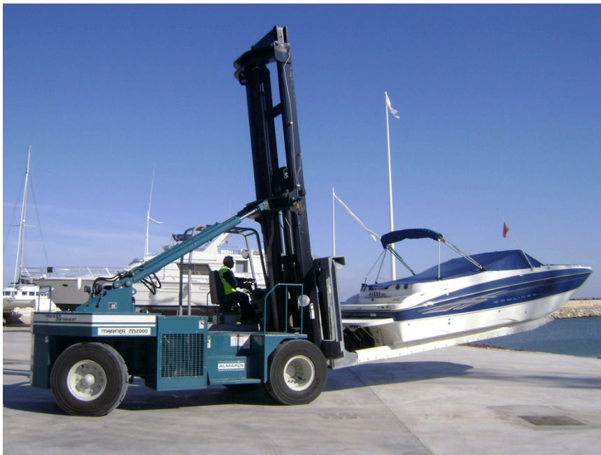
Rys. 4.40. Portowy wózek widłowy (www.panoramio.com, 2015)
