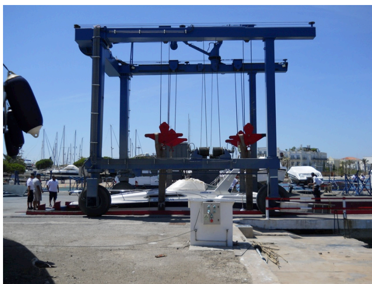
Rys. 4.38. Travelift – bramownica samojezdna opuszczająca jednostkę na wodę. Źródło: autor
