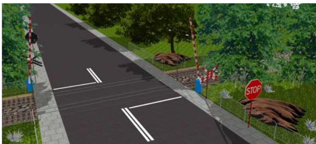
Rysunek 10. Przejazd kat. B zabezpieczony rogatekami, wyposażony w znak B-20 STOP
