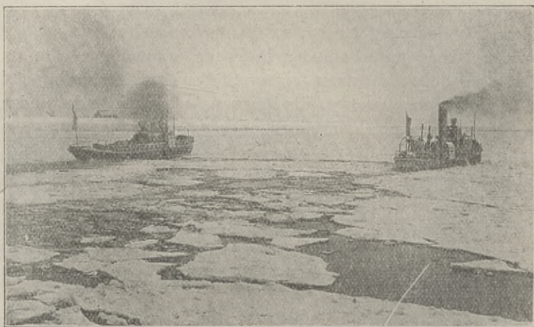
Eisbrecher auf der Weichsël, zwischen sich eine Rinne brechend.
