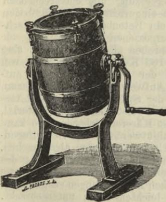
bildete Regenwalder Butterfass, das meistens aus Metall gefertigt und ebenfalls kippbar ist. Das Schlägerwerk besteht aus 4 oder 5 bogenförmigen, durchlöchernten Holzplatten. Es ist ein Mangel dieser
