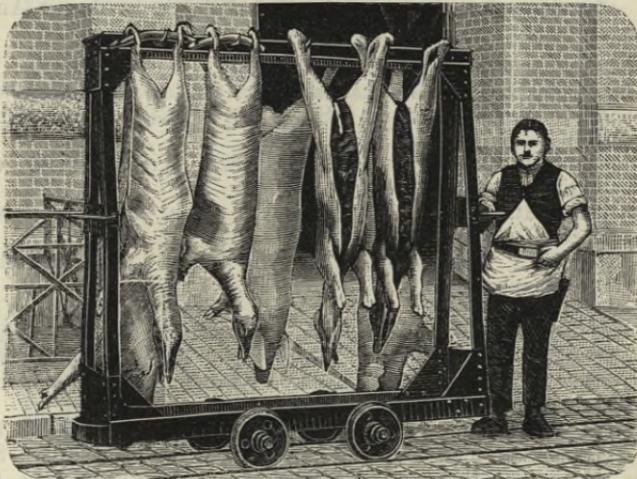
Fig. 186. Es können an einen solchen Wagen 10—12 Stück Vieh in ausgeschlachtetem Zustande angehängt und durch einen Mann bewegt werden. Derartige Wagen sind insbesondere auf Schlachthöfen angebracht, auf denen das Kühlhaus von den Schlachthallen weit entfernt liegt.
