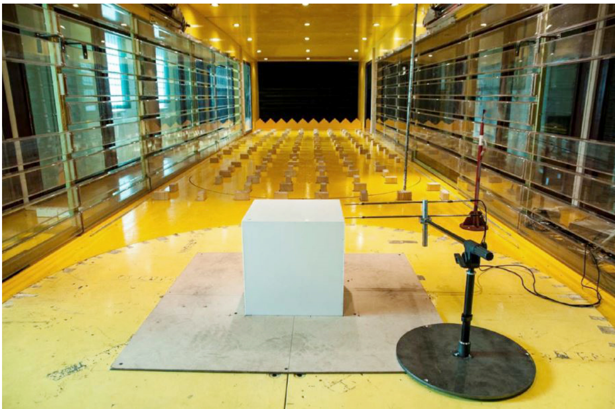
Il. 5.4 Widok bryły 1 wraz z elementami układu pomiarowego we wnętrzu tunelu aerodynamicznego. Fot. Łukasz Flaga.
