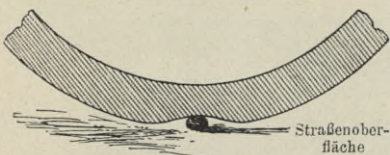
Fig. 94. Gewebe mit gespanntem Faden und straffer oder gedehnter Lauffläche über einen Stein fahrend.
