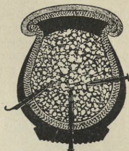
Fig. 171. Mit Kork gefüllter unverletzlicher Reifen.
