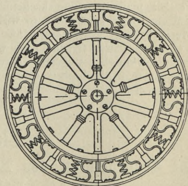
Fig. 183. Gefederter Radkranz, deutsches Fabrikat.
