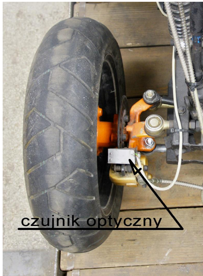
Rys. 82 Transoptor do pomiaru prędkości jazdy
