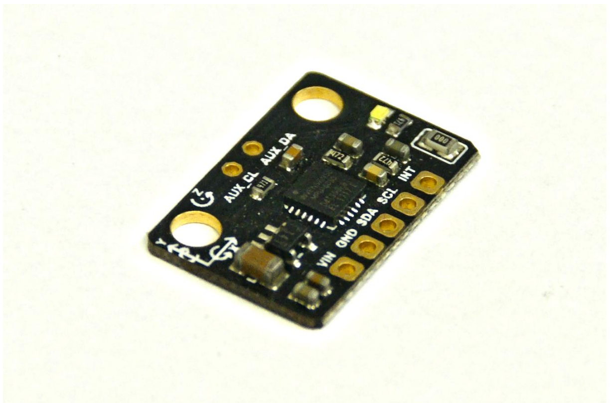
Rys. 81 Sześciooosiowe urządzenie MPU-6050
