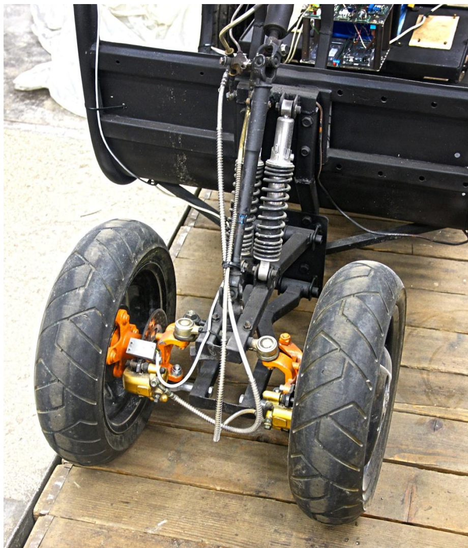
Rys. 26 Przednie zawieszenie z podwójnym wahaczem pchanym
