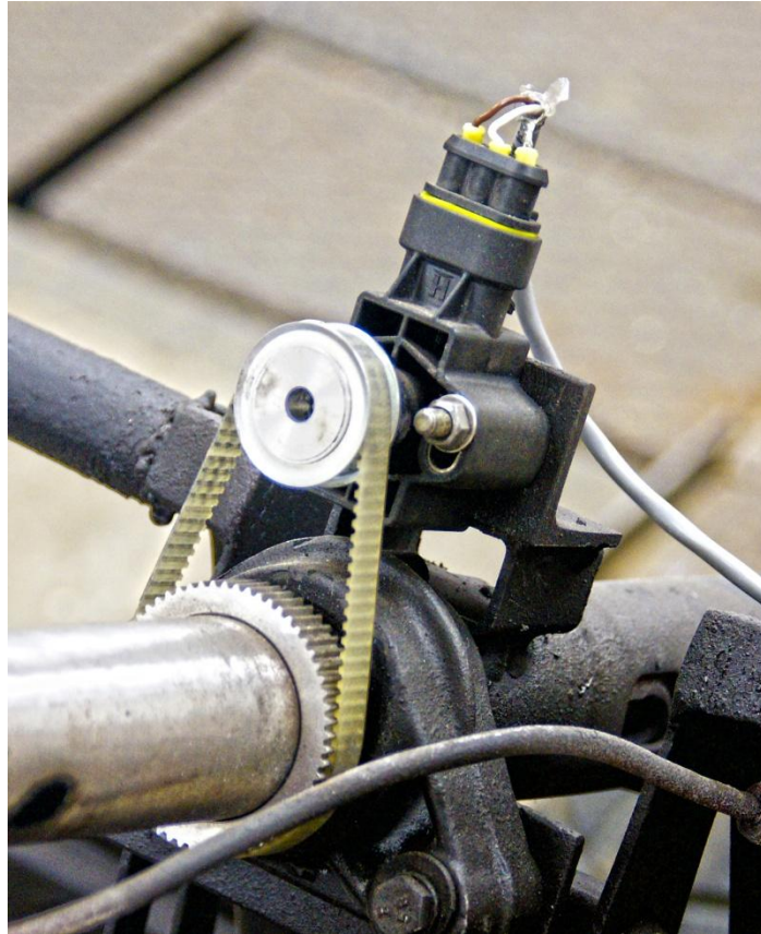
Rys. 80 Czujnik obrotu koła kierownicy połączony przekładnią z paskiem zębatym
