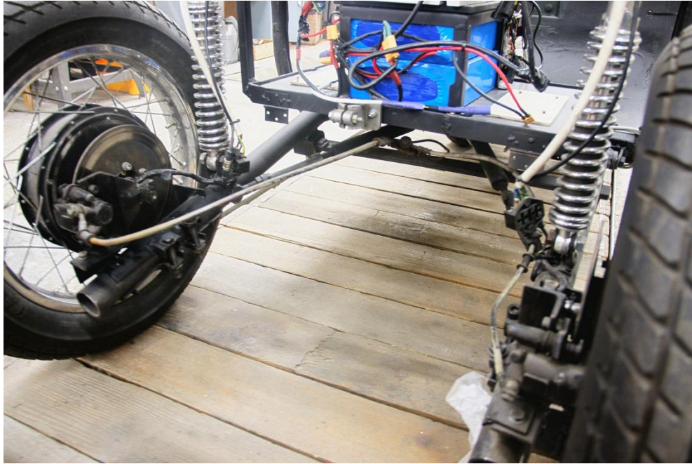
Rys. 27 Tylne zawieszenie pojazdu MIST
