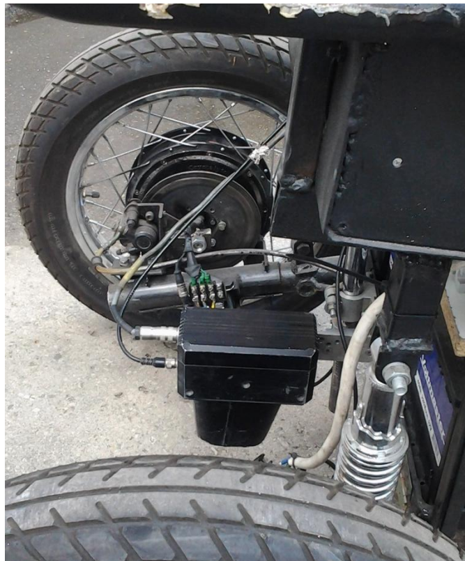
Rys. 39 Głowica pomiarowa Datron Correvit
