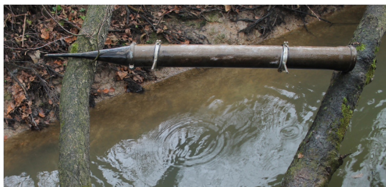
Fot. 5.1. Zdjęcie batometru BS-2 zamontowanego w potoku Wolnica Źródło: (fot.: Zemelka)
