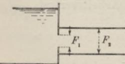
Bei Ausfluß aus einem Gefäß durch einen scharfkantigen *Scheibenring* mit dem Öffnungsquerschnitt  $F_1$  in ein mit der Geschwindigkeit  $U$  durchströmtes Ansatzrohr vom Querschnitt  $F_2$  oder bei dem Durchfluß durch einen solchen
