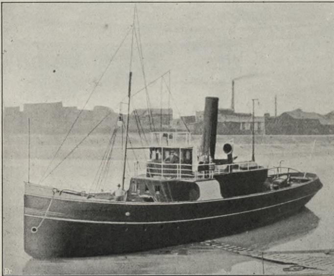
Abb. 434. Schraubenschleppdampfer auf dem Rhein.
