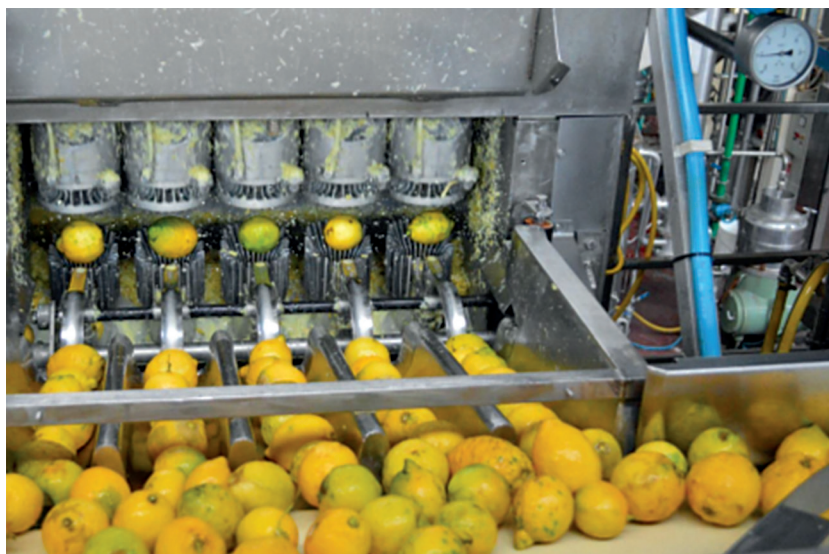
Rys. 38. Zdjęcie urządzenia do równoczesnego pozyskiwania soku i olejku metodą FMC [66]
