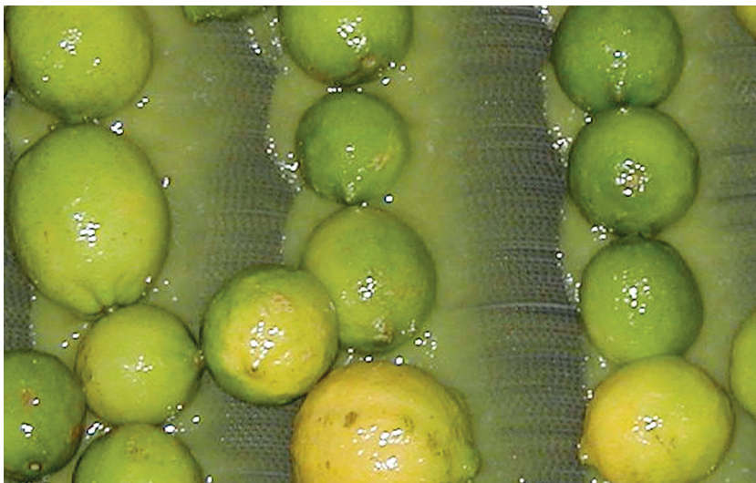
Rys. 41. Rolki ekstraktora olejku eterycznego z obracającymi się na nich owocami pokryte cienką warstwą wody [66]
