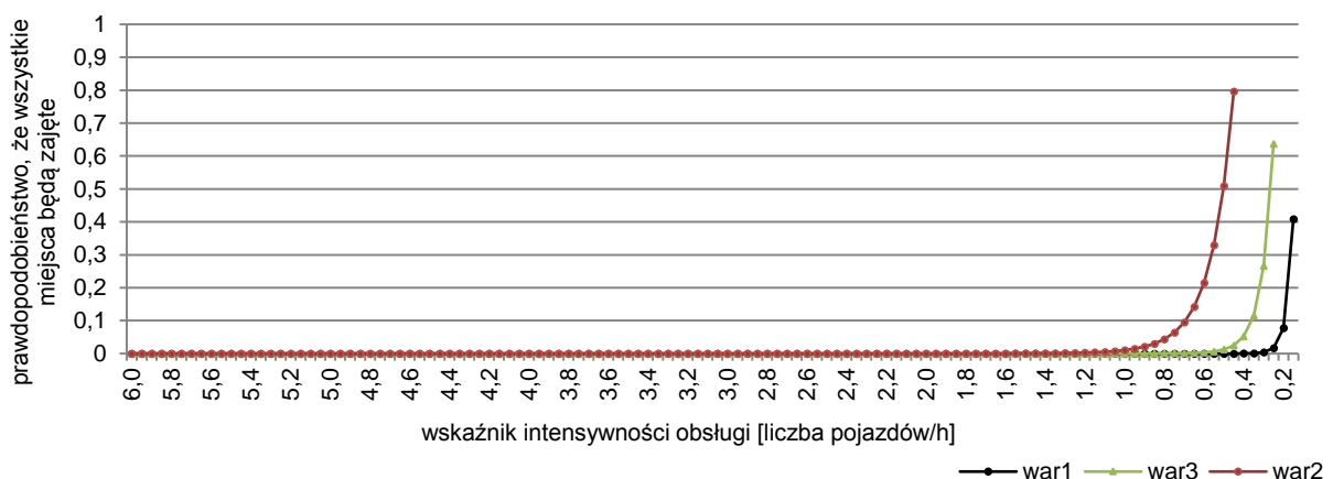
Rys. 4.4. Zależność wielkości prawdopodobieństwa, że wszystkie miejsca parkingowe będą zajęte od intensywności obsługi pojazdów w systemie – w zakresie od 6 do 0,1 pojazdu w godzinie, tj. od 10 do 480 min postoju | WinQSB Źródło: opracowanie własne przy użyciu programu WinQSB
