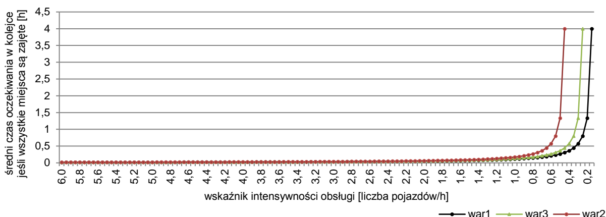
Rys. 4.5. Zależność średniego czasu oczekiwania w kolejce przy 100% zajętości parkingu od intensywności obsługi pojazdów w systemie – w zakresie od 6 do 0,1 pojazdu w godzinie, tj. od 10 do 480 min postoju | WinQSB Źródło: opracowanie własne przy użyciu programu WinQSB
