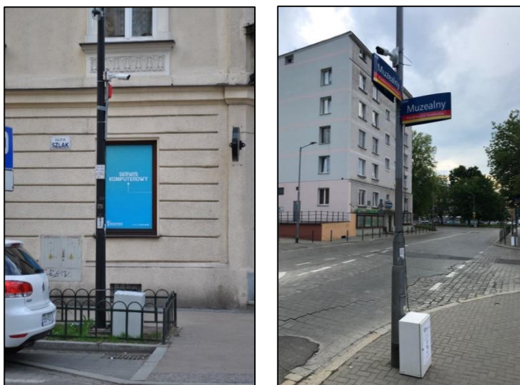
Rys. 3.13. Zestawy kamerowe wykorzystane do pomiaru ruchu w Krakowie (z lewej) i we Wrocławiu (z prawej) Źródło: fotografie własne
