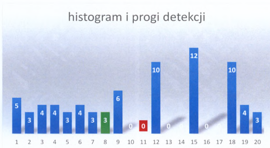
Il. 7.11. Rozkład poziomów szarości dla wyrównanego histogramu oraz progi detekcji zaznaczone zielonym kolorem dla maksimum entropii i czerwonym kolorem dla minimum wariancji
