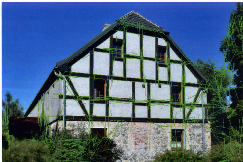
Il. 10.5. Obraz budynku z naniesionymi odcinkami prostych, wyznaczonymi za pomocą transformaty Hougha. Opis w tekście
