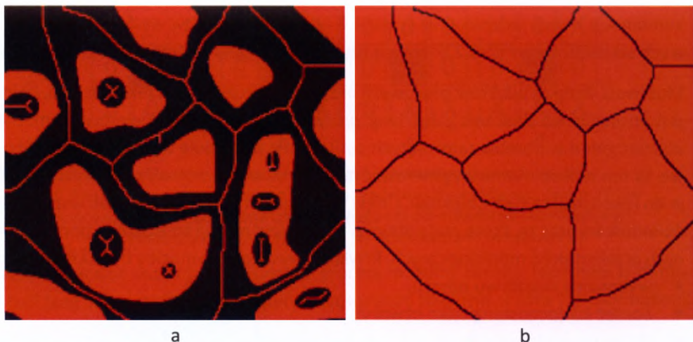
Il. 8.23. Negatyw obrazu obiektów oraz ich szkieletów (a) oraz negatyw szkieletu z il. (a) po obcięciu gałęzi, czyli SKIZ wyjściowego obrazu
