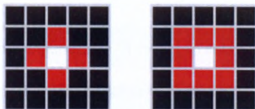
Il. 12.3. Modele najbliższego sąsiedztwa: 4-punktowe (z lewej) oraz 8-punktowe (z prawej)
