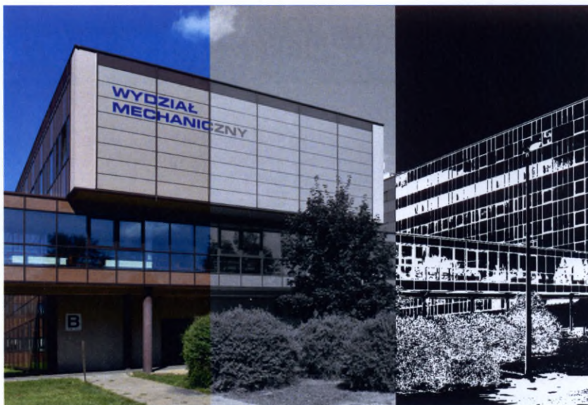
Il. 7.2. Porównanie obrazu kolorowego, szarego i binarnego
