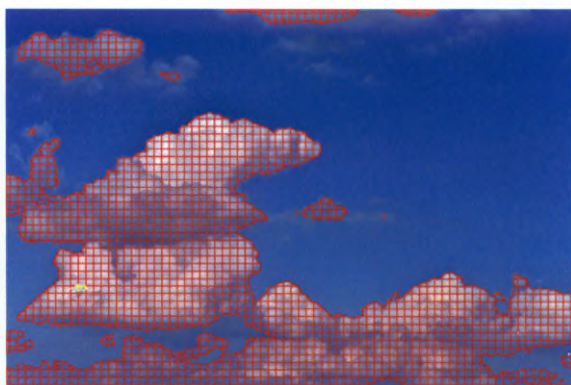
Il. 9.20. Wynik detekcji chmur, przeprowadzonej na podstawie składowej nasycenia, nałożony na obraz początkowy
