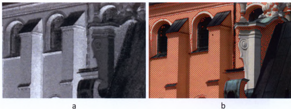
Il. 9.28. a) składowa b modelu Lab, b) wynik detekcji nałożony na obraz początkowy
