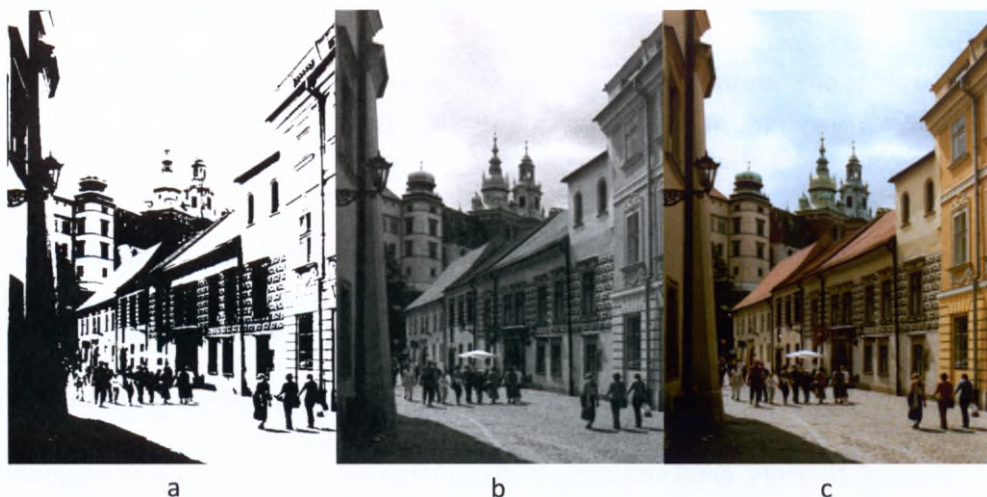
II. 2.6. Podstawowe rodzaje obrazów: a) obraz binarny, b) obraz szary, c) obraz kolorowy
