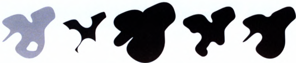
Il. 8.3. Szara figura wyjściowa oraz kolejno od lewej do prawej: figura po erozji, dylatacji, otwarciu i zamknięciu
