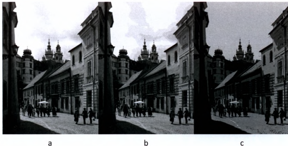
Il. 2.8. Zmiana głębokości bitowej obrazu: a) 6 bitów – 64 odcienie szarości, b) 4 bity – 16 odcieni szarości, c) 2 bity – 4 odcienie szarości
