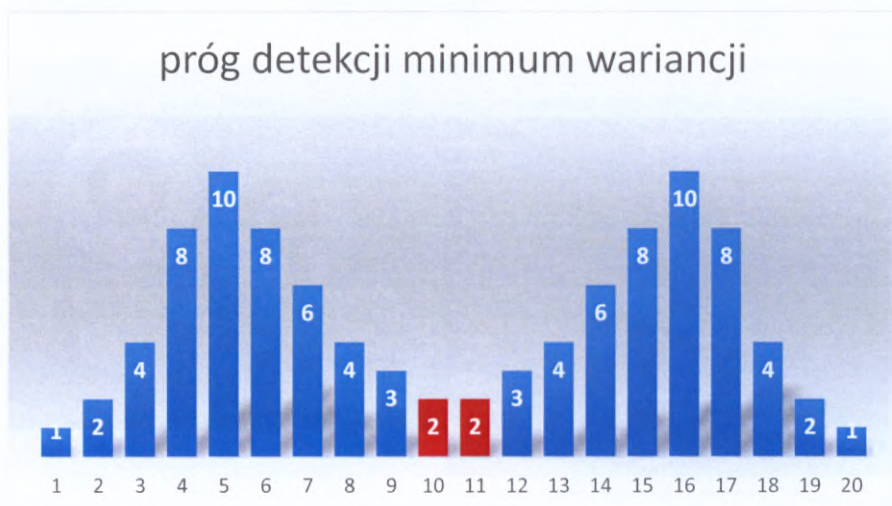
Il. 7.8. Rozkład poziomów szarości oraz próg detekcji zaznaczony czerwonym kolorem
