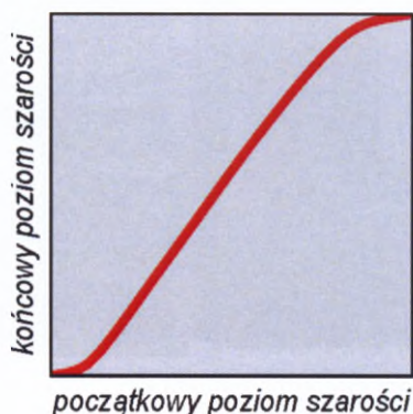
Il. 4.28. Schemat S-kształtnej funkcji używanej do wstępnej korekty obrazów. Opis w tekście
