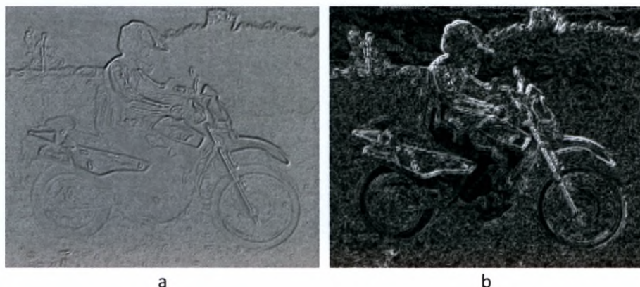
Il. 5.31. Różnica pomiędzy krawędziami wykrytymi filtrem Roberta i Sobela:
