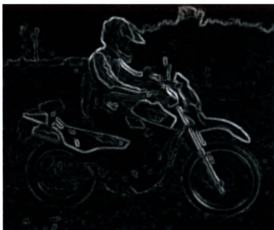
Il. 5.15. Detekcja krawędzi obrazu z il. 5.8a, uzyskana jako różnica wyników filtracji maksymalnej i minimalnej
