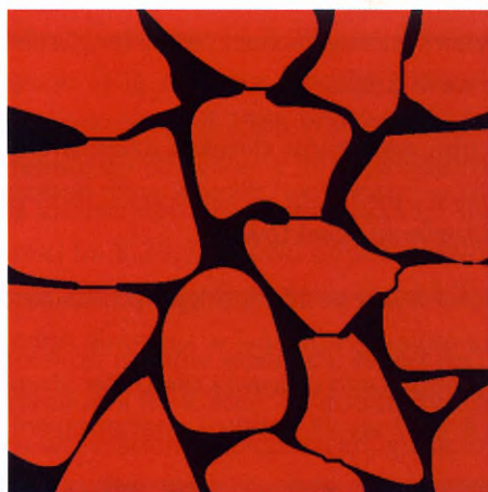
Il. 8.32. Podział sklejonych obiektów z wykorzystaniem operacji SplitConvex w systemie Aphelion
