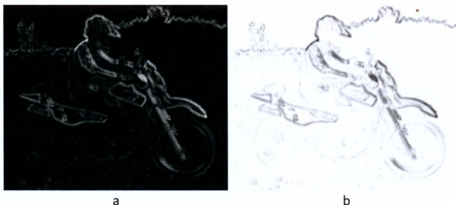
Il. 5.32. Krawędzie otrzymane algorytmem Canny–Deriche (a) oraz negatyw tego obrazu krawędzi (b)
