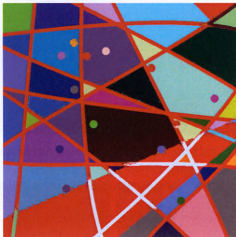
Il. 7.26. Etykietowany obraz segmentacji obrazu z il.7.17a, otrzymany metodą rozrostu obszarów przy progu dopuszczalnej różnicy, wynoszącym 28
