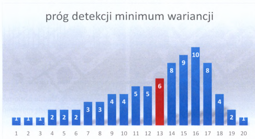
Il. 7.12. Automatyczny wybór progu detekcji dla metody minimum wariancji w przypadku histogramu wykazującego tylko jedno maksimum. Metoda maksimum entropii daje podobny wynik
