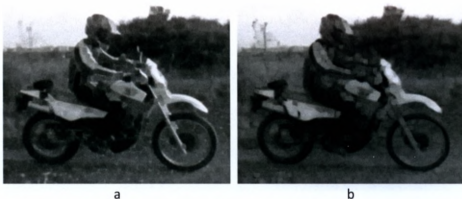
Il. 5.11. Filtrowanie obrazów: a) złożenie filtra maksymalnego i minimalnego (zamknięcie), b) złożenie filtra minimalnego i maksymalnego (otwarcie). Matryca filtru: 5x5
