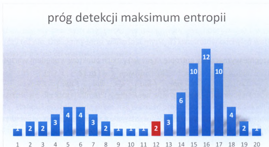
Il. 7.10. Rozkład poziomów szarości oraz próg detekcji zaznaczony czerwonym kolorem. Wykres dla minimum wariancji jest identyczny
