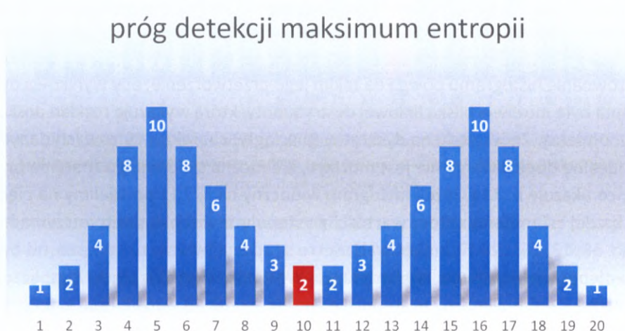
Il. 7.9. Rozkład poziomów szarości oraz próg detekcji zaznaczony czerwonym kolorem
