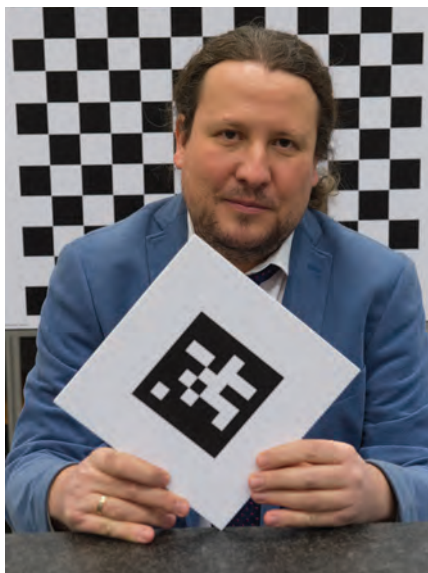
Adam Gaska z markerem referencyjnym, stosowanym w optycznych metodach pomiarowych; w tle znajduje się wzorzec do kalibracji tego typu systemów
