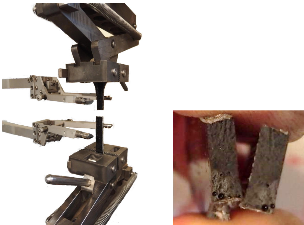
Rys. 4.13. Postać zniszczenia próbki polimeru PT poddanej rozciąganiu: widok po zerwaniu próbki (po lewej), obraz struktury polimeru w przekroju w powiększeniu (po prawej)
