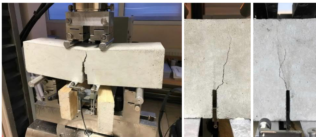
Rys. 4.22. Obraz zniszczenia próbek betonowych (przed naprawą) w czteropunktowym zginaniu – obraz przebiegu rysy
