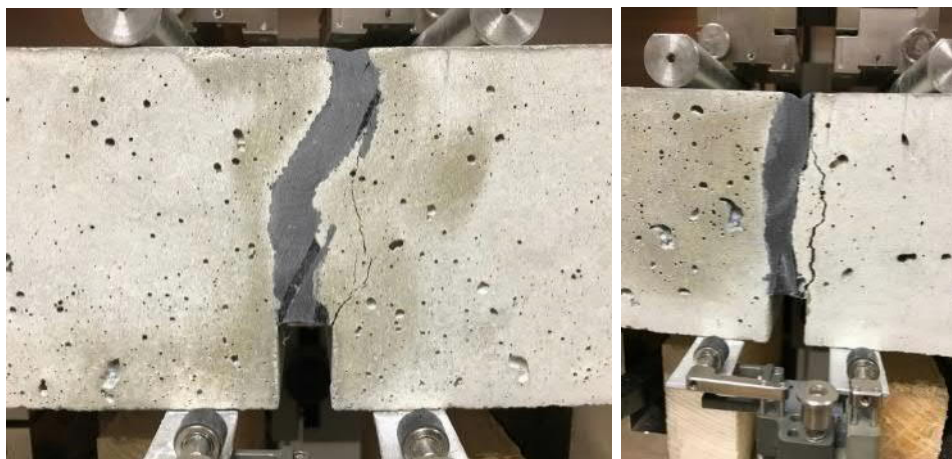
Rys. 4.24. Obraz zniszczenia próbek betonowych po naprawie złączem podatnym typu PT w czteropunktowym zginaniu – obraz przebiegu rysy
