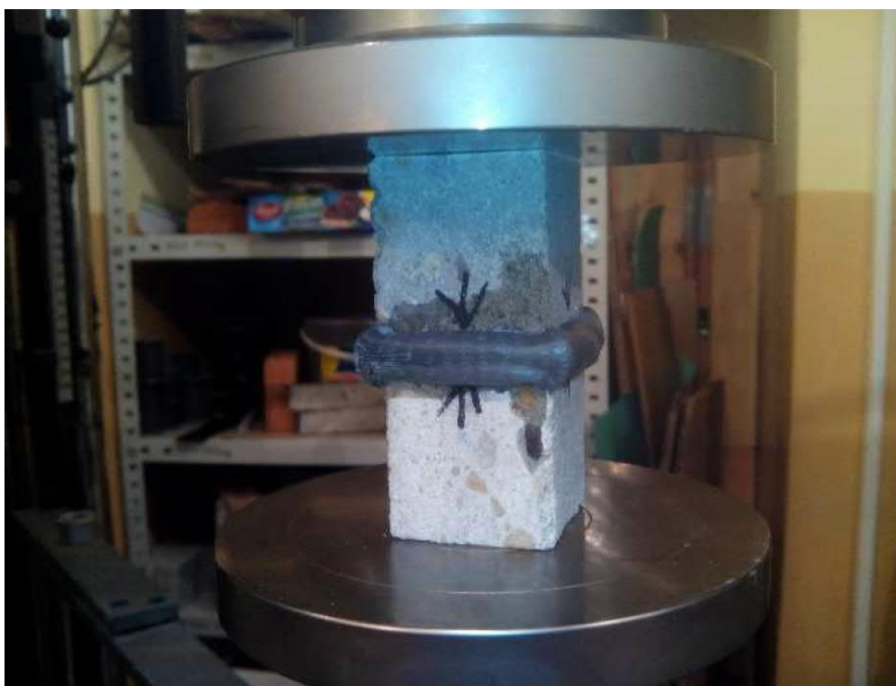
Rys. 3.39 Stanowisko badawcze jednoosiowego ściskania złącza podatnego (Kisiel, 2018)
