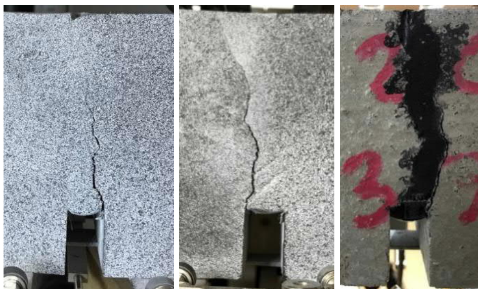
Rys. 4.54. Obraz zniszczenia próbek betonowych po naprawie złączem podatnym typu PT bez warstwy gruntującej – obraz zniszczenia
