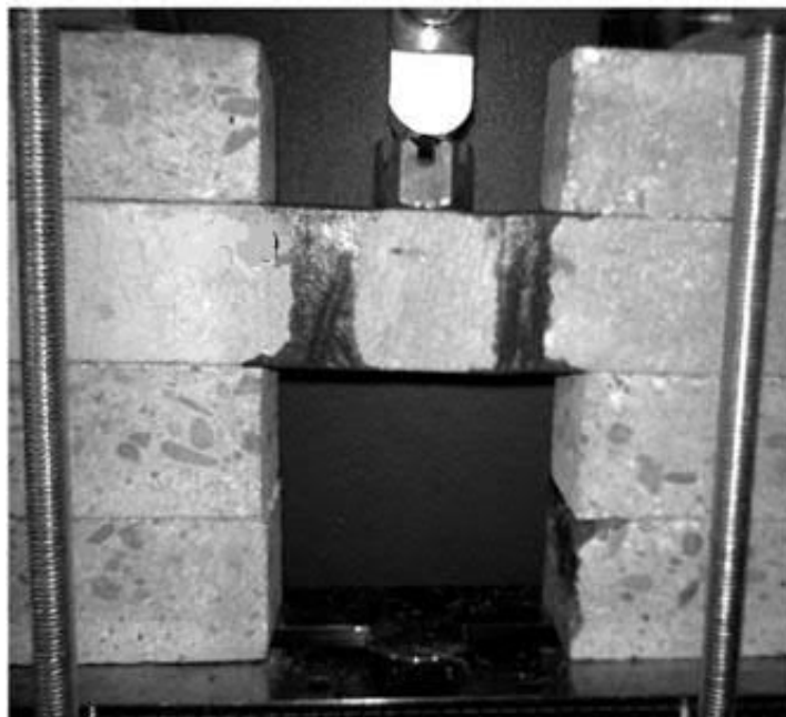
Rys. 3.43 Stanowisko badawcze ścinania złącza podatnego (Kwiecień, 2012)
