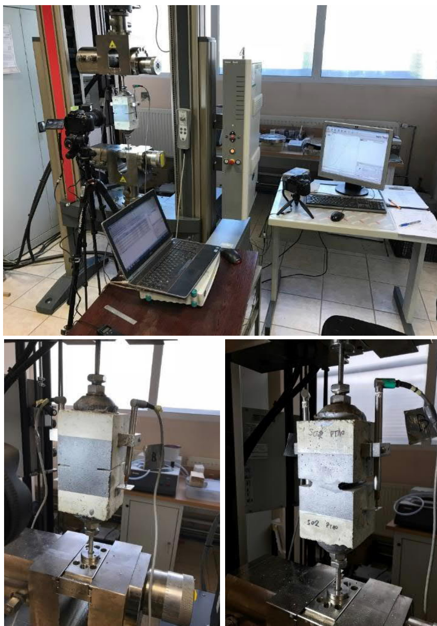
Rys. 4.9. Stanowisko badawcze jednoosiowego rozciągania
