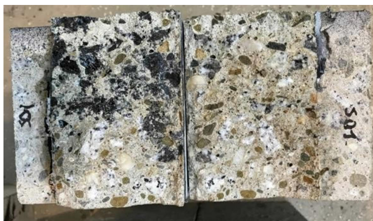
Rys. 4.25. Obraz zniszczenia próbek betonowych po naprawie złączem podatnym typu PT w czteropunktowym zginaniu – widok powierzchni uszkodzenia
