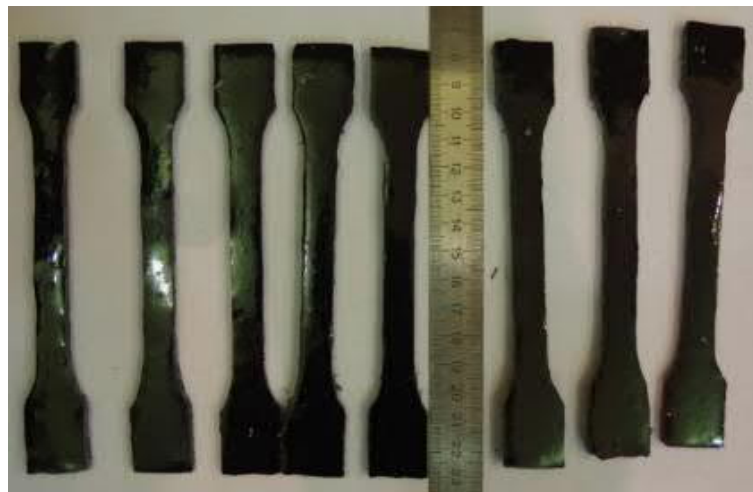
Rys. 4.6 Geometria próbki polimeru w badaniu na jednoosiowe rozciąganie zgodnych z (ISO 527-2, 2012)
