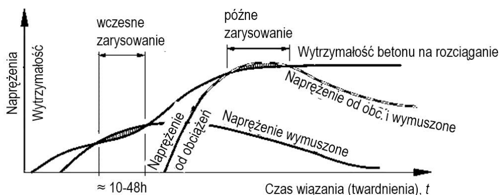
Rys. 2.6 Schemat rozwoju naprężeń wywołanych odkształceniami wymuszonymi i obciążeniem w porównaniu do rozwoju wytrzymałości betonu na rozciąganie w czasie (Lohmeyer et al., 2004)
