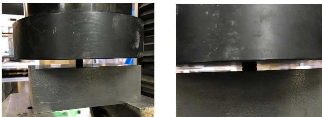
Rys. 3.21. Badanie na ściskanie normowych próbek polimeru typu PT (Pelka, 2018a)
