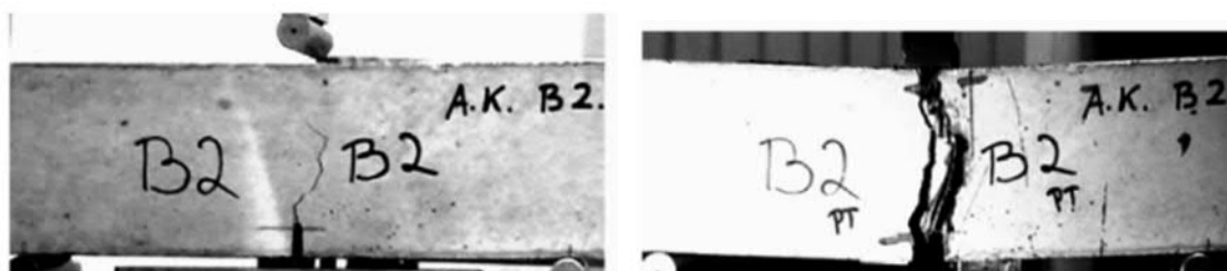
Rys. 3.36 Postać zniszczenia beleczek betonowych b \times h \times L = 100 \times 100 \times 500 \text{ mm}^3 przed i po naprawie złączem podatnym typu PT – trzypunktowe zginanie (Komardin, 2010)
