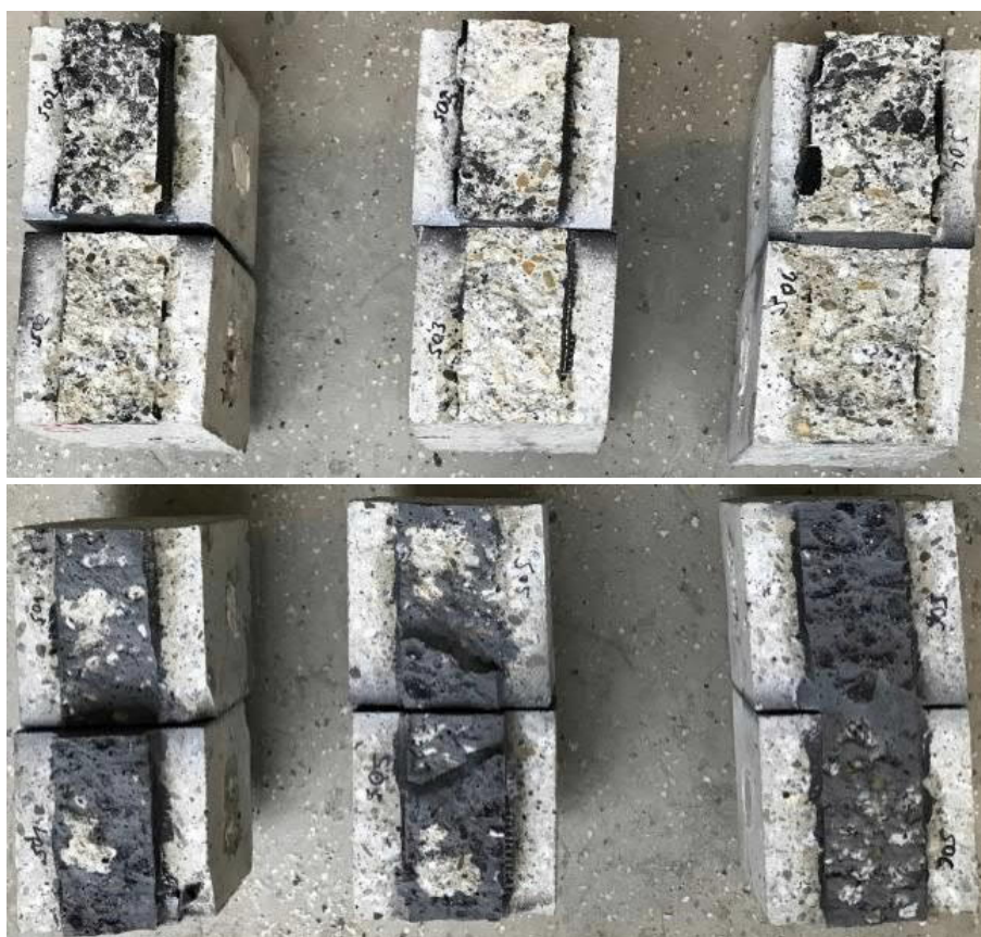
Rys. 4.49. Obraz zniszczenia próbek betonowych po naprawie złączem podatnym typu PT (na górze) i PS (na dole) w jednoosiowym rozciąganiu – widok powierzchni uszkodzenia
