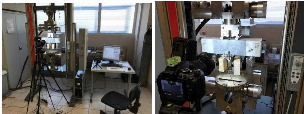
Rys. 4.8. Stanowisko badawcze – czteropunktowe zginanie
