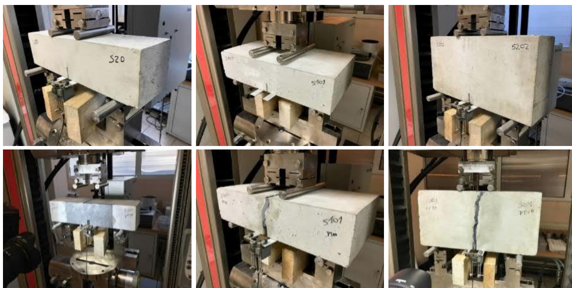
Rys. 4.4. Geometrie elementów betonowych przed (u góry) i po sklejeniu (na dole) polimerowym złączem podatnym: próbki o przekroju b \times h = 100 \times 100 \text{ mm}^2 (po lewej), 200 \times 100 \text{ mm}^2 (w środku) i 100 \times 200 \text{ mm}^2 (po prawej).
