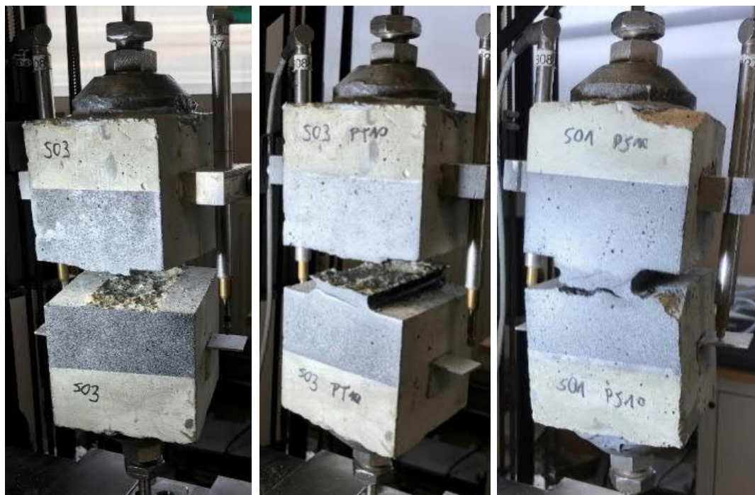
Rys. 4.48. Obraz zniszczenia próbek betonowych przed naprawą (po lewej) i po naprawie złączem podatnym typu PT (w środku) i PS (po prawej) – jednoosiowe rozciąganie
