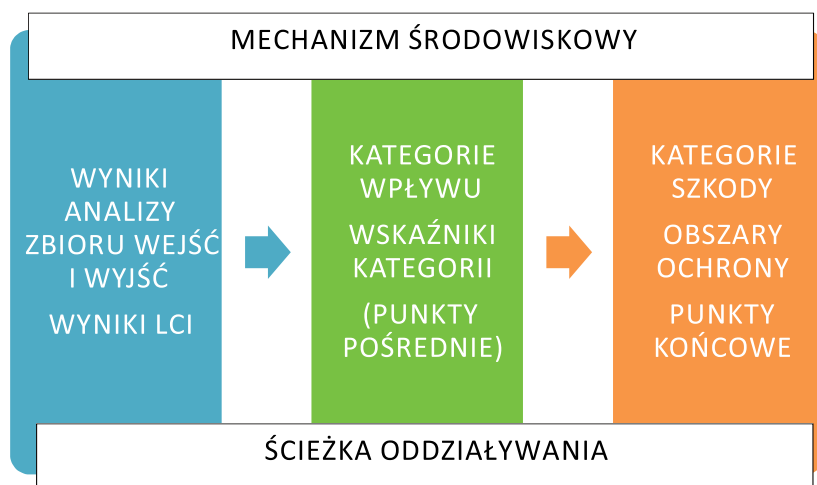
Rys. 13. Schemat ideowy trzeciej fazy LCA – analizy wpływu cyklu życia (LCIA) – opracowanie własne na podstawie [25, 256, 273]
