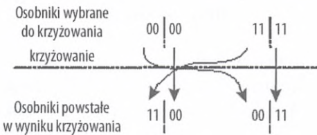
Rysunek 9.5. Schemat jednopunktowego krzyżowania wymieniającego
