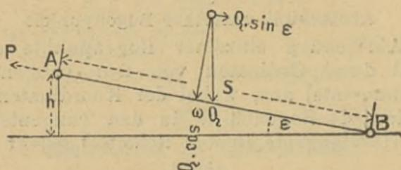
Punkte dieser beiden Kurven dar, so muß der Punkt  $A$  der äußeren Kurve um so viel gegen den Punkt  $B$  der inneren Kurve überhöht werden, daß dadurch die Wirkung der Zentrifugalkraft eines passierenden Fahrzeuges möglichst vollkommen aufgehoben wird. Bezeichnet
