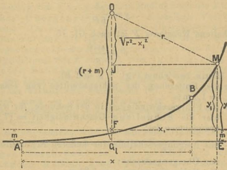
Für diejenigen Fälle, in denen die Absteckung des Kreisbogens infolge örtlicher Hindernisse nicht von der Tangente aus erfolgen kann, ist durch die Gleichungen 21, 22 und 26 ein Mittel geboten, die Richtung der im Anschlußpunkt  $B$  angelegten Tangente zu bestimmen, indem durch Gl. 21 und 22 die Lage des Punktes  $B$  selbst und durch Gl. 26 die Lage des Schnittpunktes jener Tangente mit der Abszissenachse gegeben
