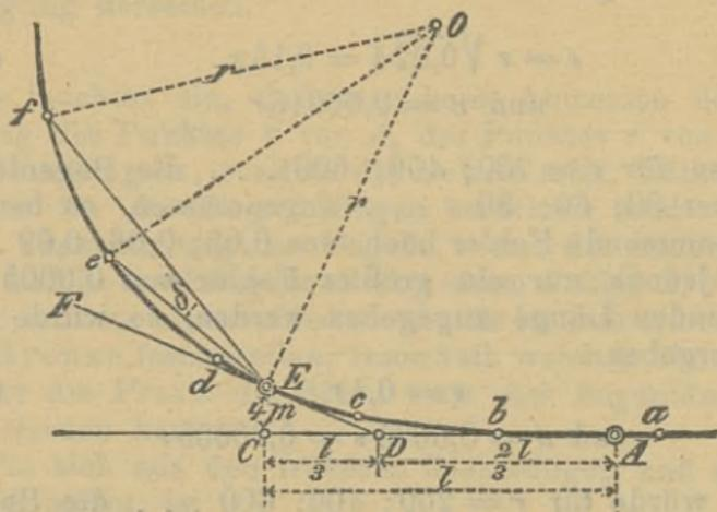
Zur Festlegung des Punktes  $E$  sind in der Tabelle III und V die Werte der Abszisse  $AC = l$  und der Endordinate  $CE = 4m$  für die vorkommenden Radien angegeben, und diese Festlegung kann mit der Absteckung
