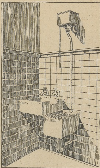
Abb. 206. Schmutzausguß und Wasserzapfstelle im Reinmacheraum
