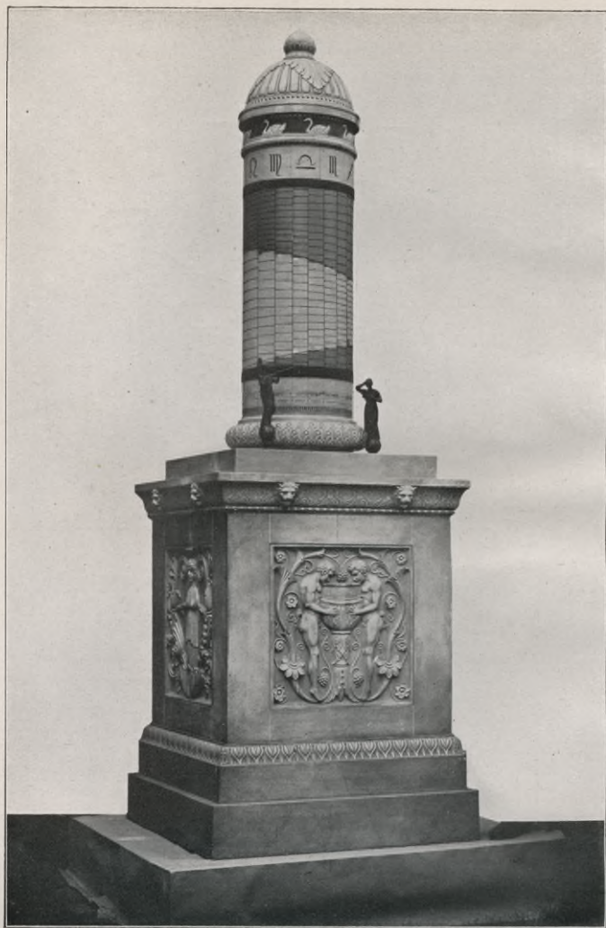
130. Ein Meisterwerk der Uhrmacherskunst: die Uhr des Ktesibios (3. Jahrh. vor Chr.), die die im Altertum täglich in der Länge wechselnden Stunden anzeigt. Rekonstruktion von Hofuhrmacher Gustav Speckhart, Nürnberg, von Geh. Kommerzienrat Dr. ing. h. c. Artur Junghans in Schramberg (Württemberg) dem Deutschen Museum in München geschenkt.
