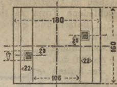
Grundriß der Unterlagsplatten auf den Zwischenschwellen.
