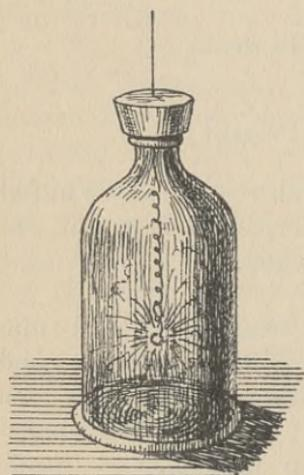
Fig. 5. Eisen in einer Sauerstoffatmosphäre brennend.
