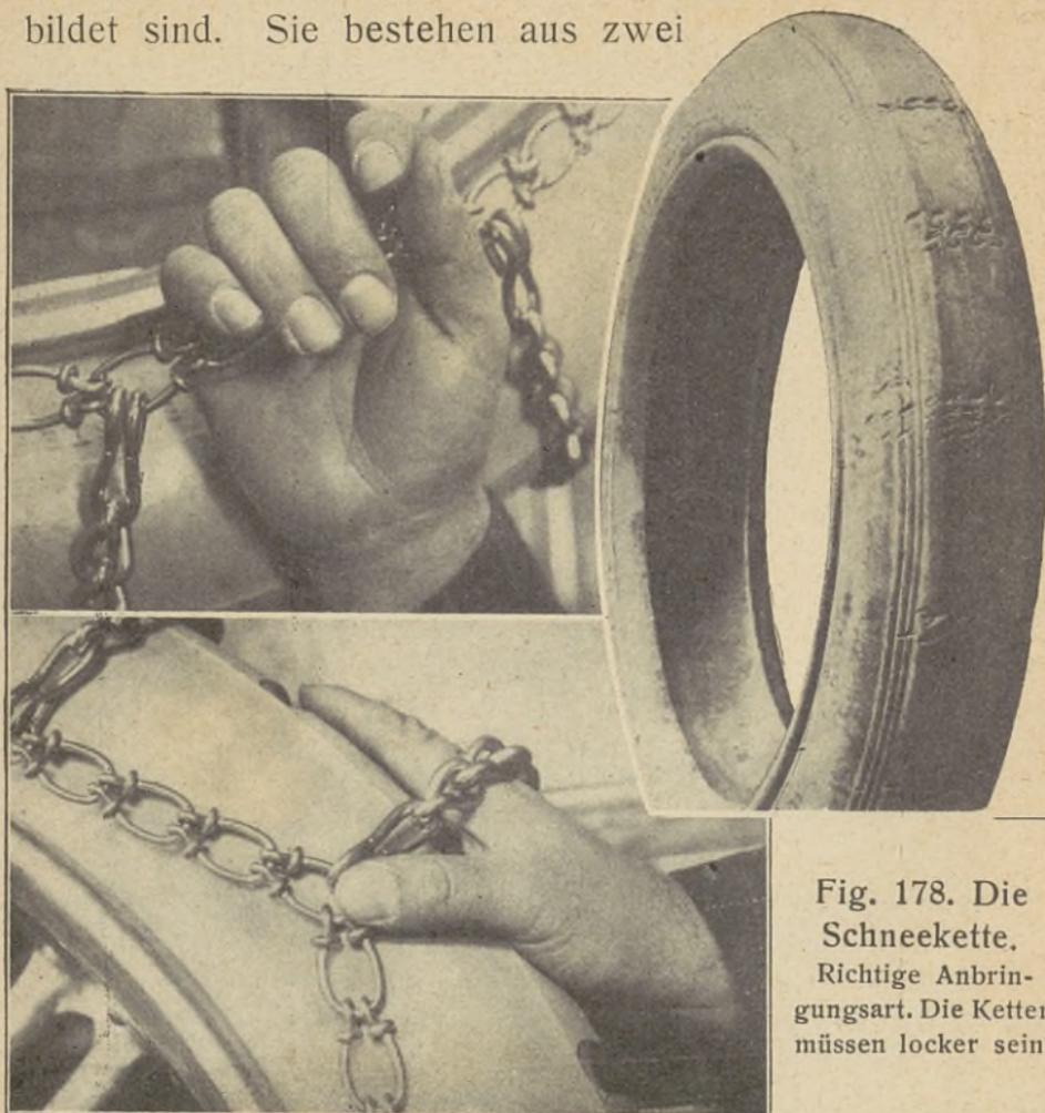
Fig. 178. Die Schneekette. Richtige Anbringungsart. Die Ketten müssen locker sein.
