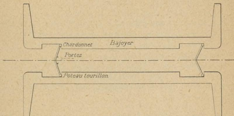
Fig. 170. — Plan d'une écluse à sas.
