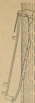
Fig. 441. — Bateau brise-glace en usage sur le canal de l'Aisne à la Marne.
