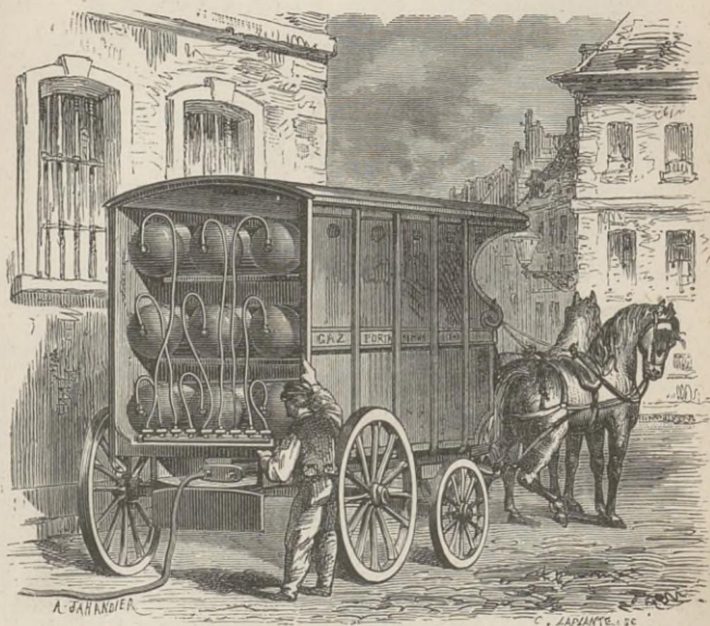
Fig. 58. — Une voiture à gaz portable.
