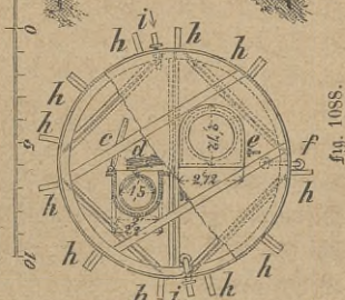
fig. 1086 bis 1088. Gründung der Brücke über die Theiß bei Szegedin.
