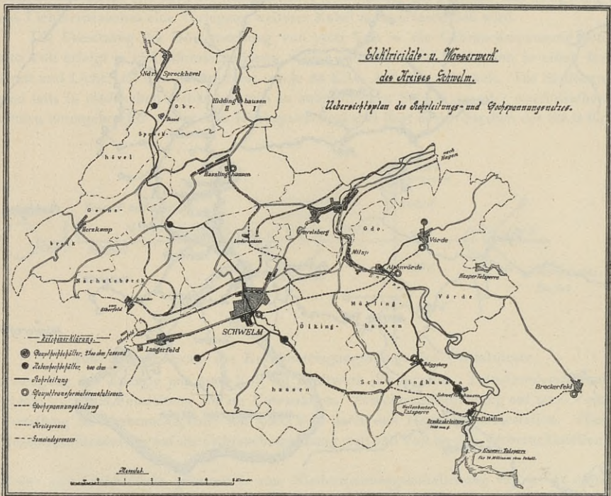
Abb. 204. Verteilungsnetz des Kraftwerkes an der Ennepetalperre (Ruhrgebiet).
