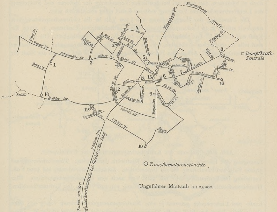
Abb. 201. Niederspannungsnetz des Elektrizitätswerkes der Stadt Solingen.
