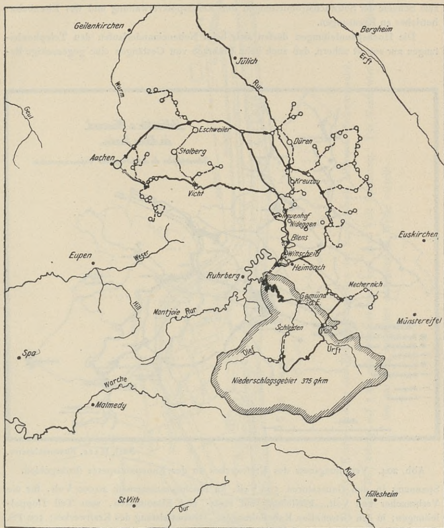
Abb. 203. Übertragungs- und Verteilungsnetz des Urfttalsperren-Elektrizitätswerkes Heimbach (Eifel).
