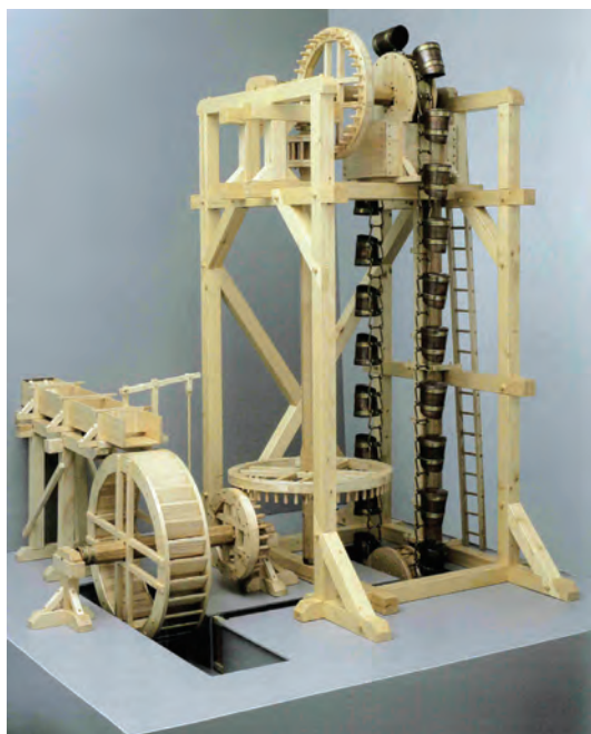
Rekonstrukcja mechanizmu pobierania wody w rurusie (Robert Wierzbiński), ilustracja w czasopiśmie „Krzysztofor” (t. 28, 2010, s. 186)
