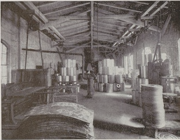
Fabrikation der Blechtrommeln zum Versand des Carbids.
